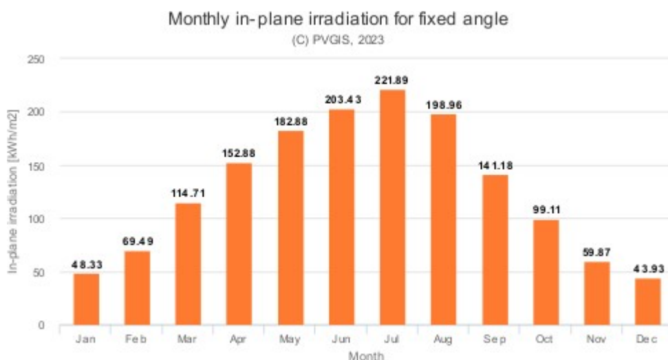
Слика 4. Очекувано количество на производство на електрична енергија за дадениот систем, со фиксен агол во kWh
